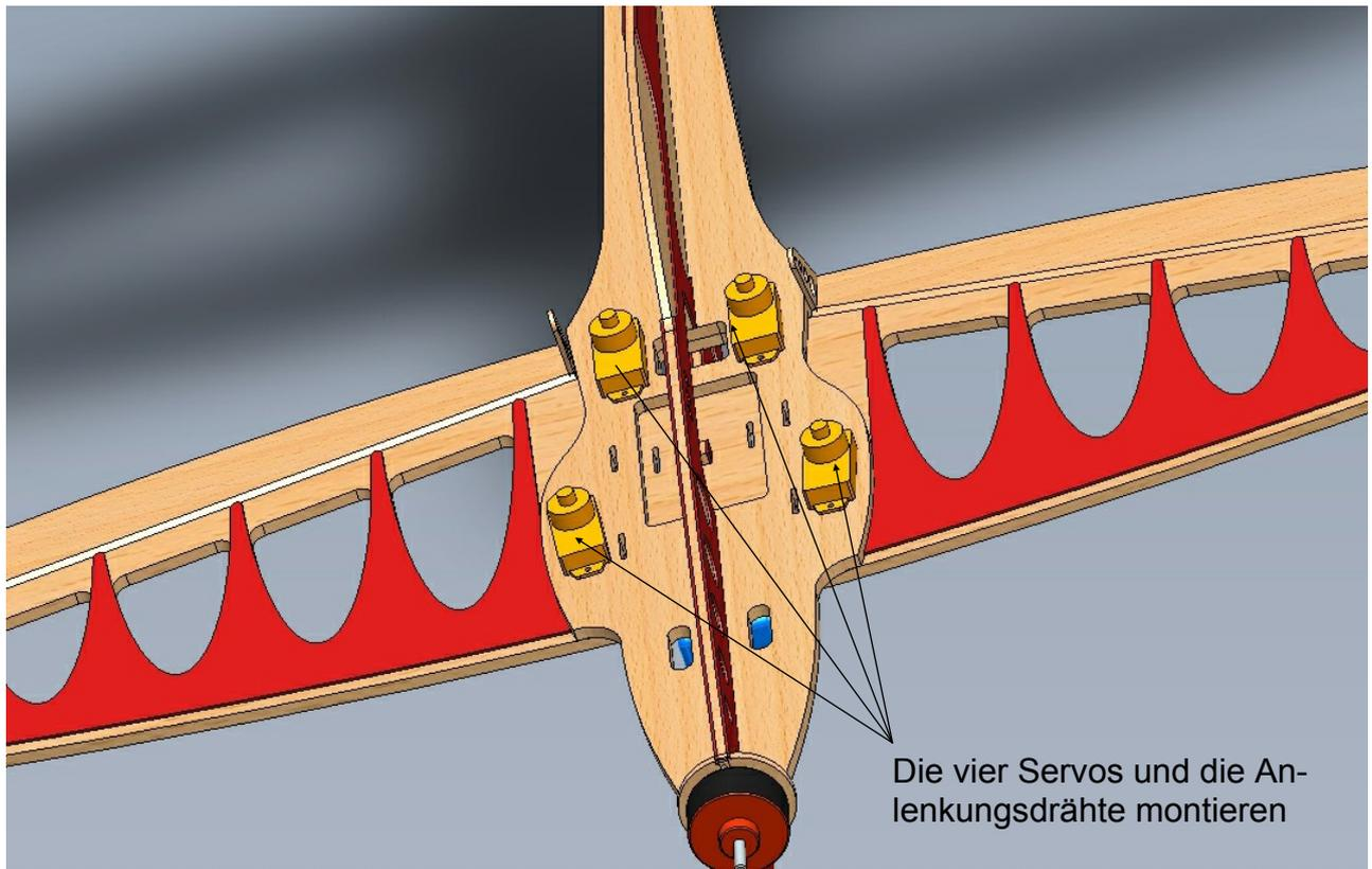
Die vier Servos und die Anlenkungsdrähte montieren
